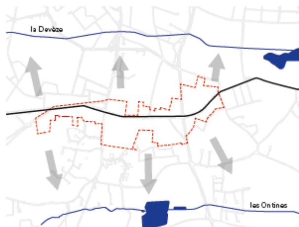
Sens des pentes et des cheminement des eaux pluviales en surface
