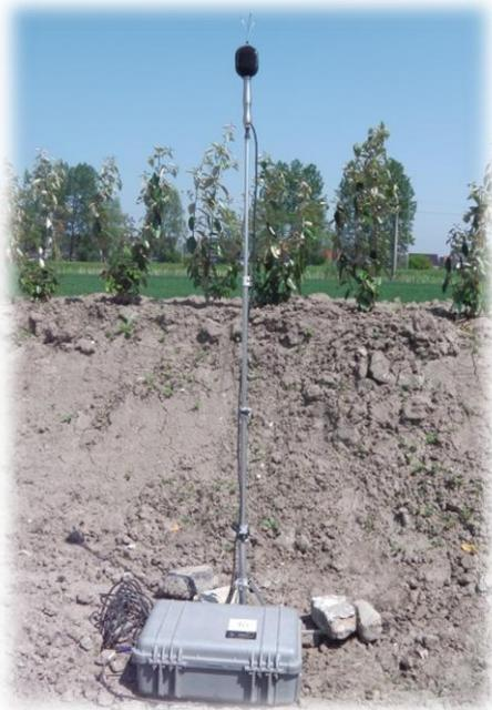
Figure 24: Photo du sonomètre mis en place sur le site.
