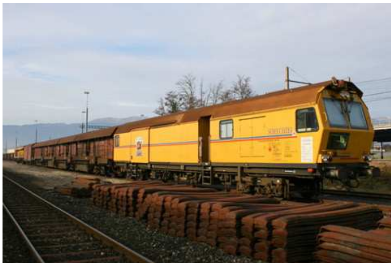
Train meuleur de rails (Scheuchzer S.A.)
