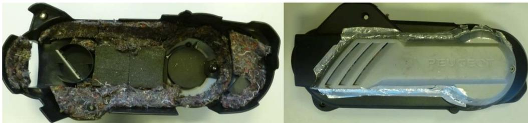
Photo 6-2 : Capotage prototype du couvercle de transmission 125cc
