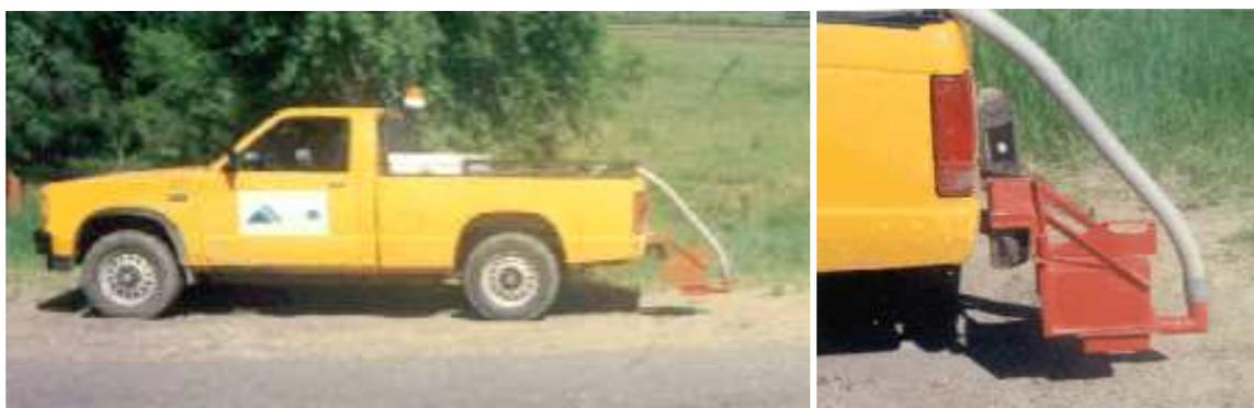
Figure 51 – Outil de prélèvement des poussières, installé à l'arrière d'un véhicule (34)
